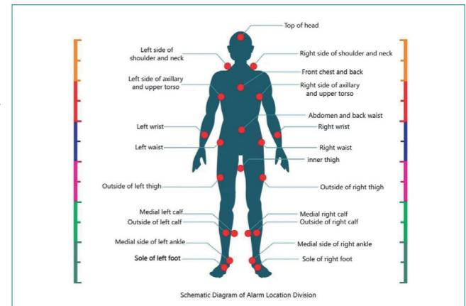
Возможность просматривать видео в режиме реального времени, информацию об обнаруженных металлических предметах на изображении фигуры тела человека, включая зону обнаружения, материал и форму подозрительных предметов, фото в момент прохода через металлодетектор, счетчик проходов и тревог.
